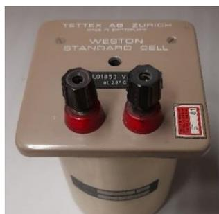
Figura XXV. Pila patrón tipo Weston (Laboratorio de UTE).
