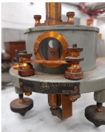
Figura VI. Sistema móvil de galvanómetro de alta sensibilidad (Laboratorio de UTE).
