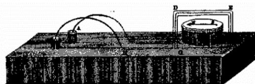
Figura II. Primeros galvanómetros. Propuesta de Cumming [3].
