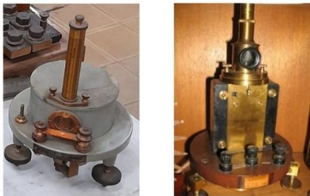
Figura IV. Galvanómetros modernos (Laboratorio de UTE).
