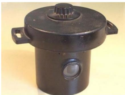
Figura VII. Galvanómetro de resonancia para corriente alterna (Laboratorio de UTE)
