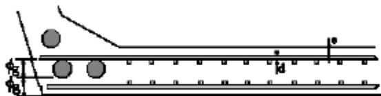
$Ec \geq 2\emptyset + d + e$  avec  $Ec \geq 18 \text{ à } 22 \text{ cm}$
