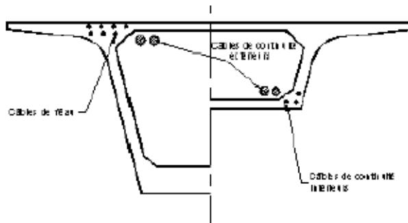
Figura XI: Definición de los cables de pretensión
