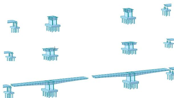
*Figura XXII: Algunas etapas constructivas del Puente sobre el Río Cuiabá Vistas del Puente sobre el Río Cuiabá*
